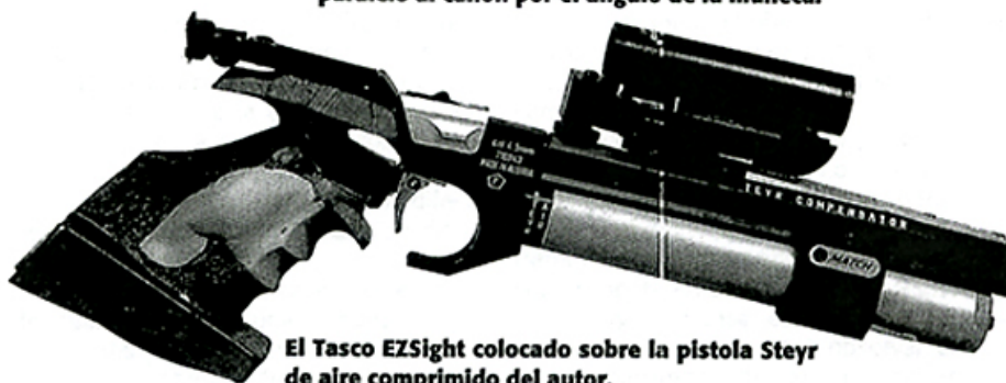
Otra vista del visor colocado sobre la Steyr. Una vez colocado, hay que ponerlo paralelo al cañón por el ángulo de la muñeca.
